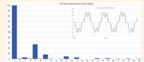
带交流电抗器时变频调速器的输入电流波形和频谱图
